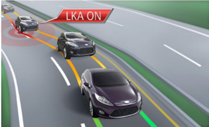
▲ 車道維持輔助系統 (LKA) 示意圖
